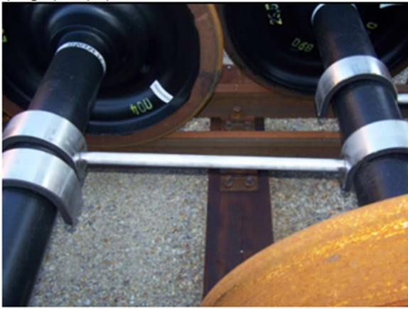
Zdjęcie 7: Składowanie na torze splecionym (podwójny tor) z dystansami
