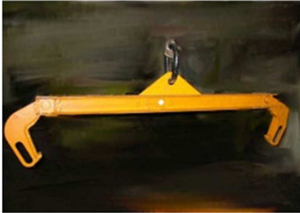
Zdjęcie 3: Zawieszanie do podnoszenia zestawów kołowych (tarcza)
