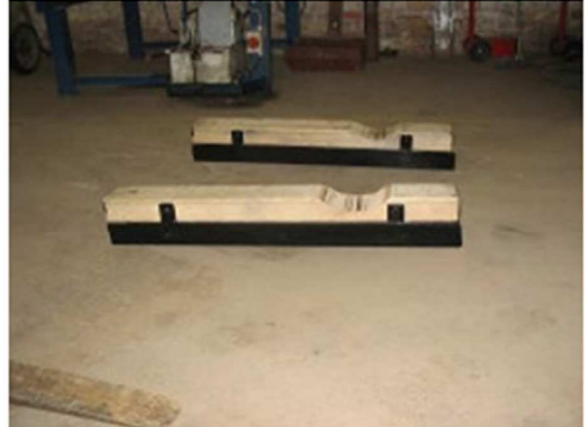
Zdjęcie 6: Uchwyt zestawu kołowego do wózka widłowego
