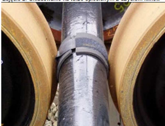
Zdjęcie 4: Składowanie na torze splecionym z zabezpieczeniem przed kontaktem
