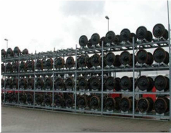
Zdjęcie 5: Składowanie zestawów na stelażach ładunkowych (magazynowych)
