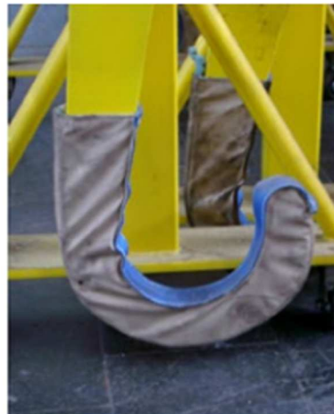
Zdjęcie 2: Zawiesie do podnoszenia zestawów kołowych, zdejmowana ochrona
