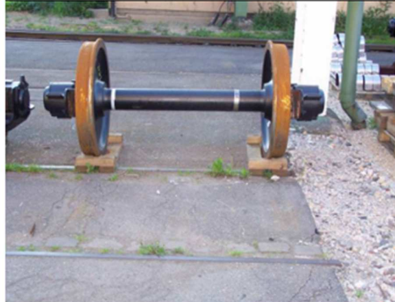
Zdjęcie 6: Składowanie na płaskim podłożu
