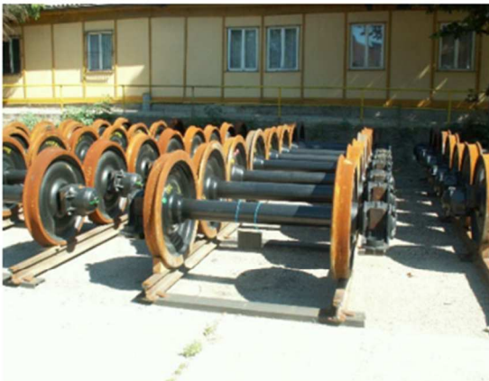
Zdjęcie 1: Przechowywanie na torze z użyciem klinów
