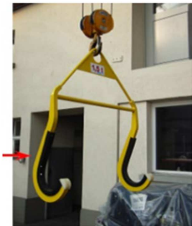
Zdjęcie 1: Zawiesie do podnoszenia zestawów kołowych (oś)
