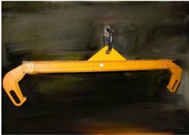
Zdjęcie 3: Zawieszony do podnoszenia zestawów kołowych (tarcza)
