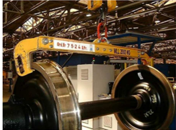
Zdjęcie 4: Zawieszony do podnoszenia zestawów kołowych (tarcza)
