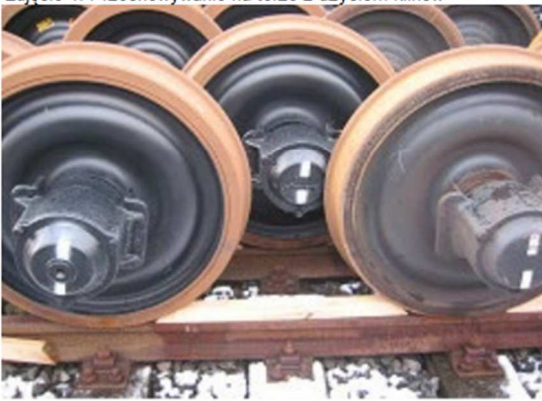
Zdjęcie 3: Składowanie na torze splecionym (podwójny tor)
