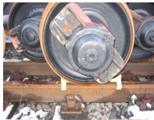
Zdjęcie 2: Składowanie na torze splecionym z użyciem klinów
