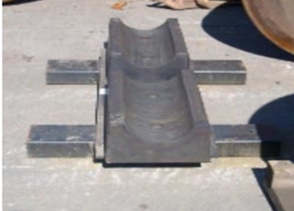
Zdjęcie 5: Uchwyt zestawu kołowego do wózka widłowego
